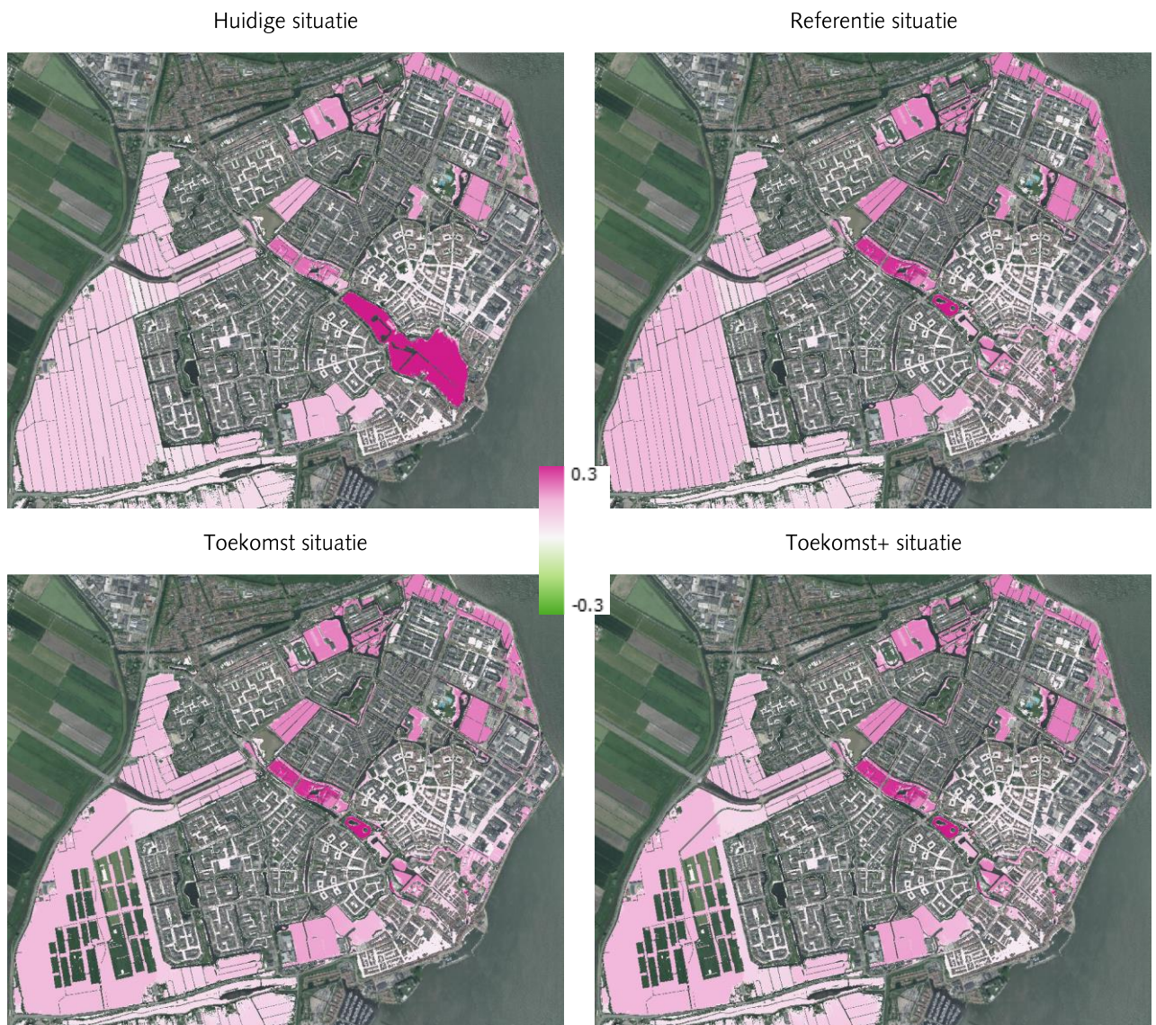
Figuur 6 Waterdiepteverschilkaarten bij een T1000-scenario van de resultaten met en zonder de nieuwste neerslagstatistiek (18-buien methodiek, incl. nieuwste neerslagstatistiek). Kleurschaling loopt van -30 tot +30 cm.
