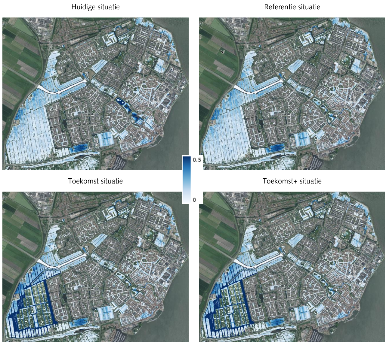
Figuur 3 Maximale waterdieptes bij een T100-scenario (18-buien methodiek, incl. nieuwste neerslagstatistiek)
