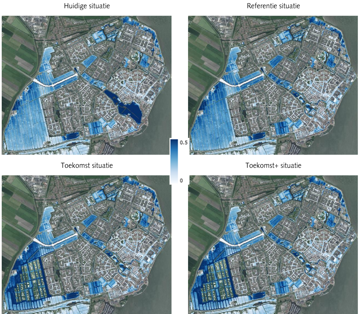
Figuur 5 Maximale waterdieptes bij een T1000-scenario (18-buien methodiek, incl. nieuwste neerslagstatistiek)
