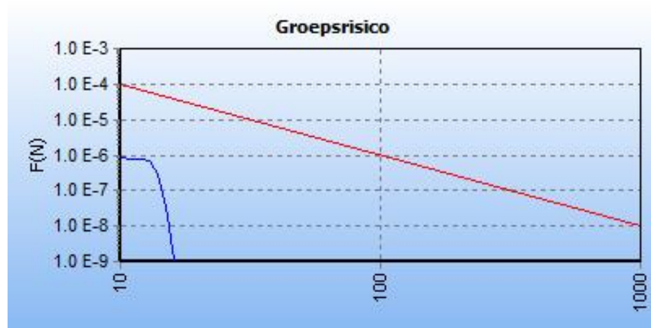
Figuur 5.12 FN-curve voor buisleiding W-570-21 van N.V. Nederlandse Gasunie, toekomstige situatie, voor de kilometer tussen stationing 300.00 en stationing 1300.00
