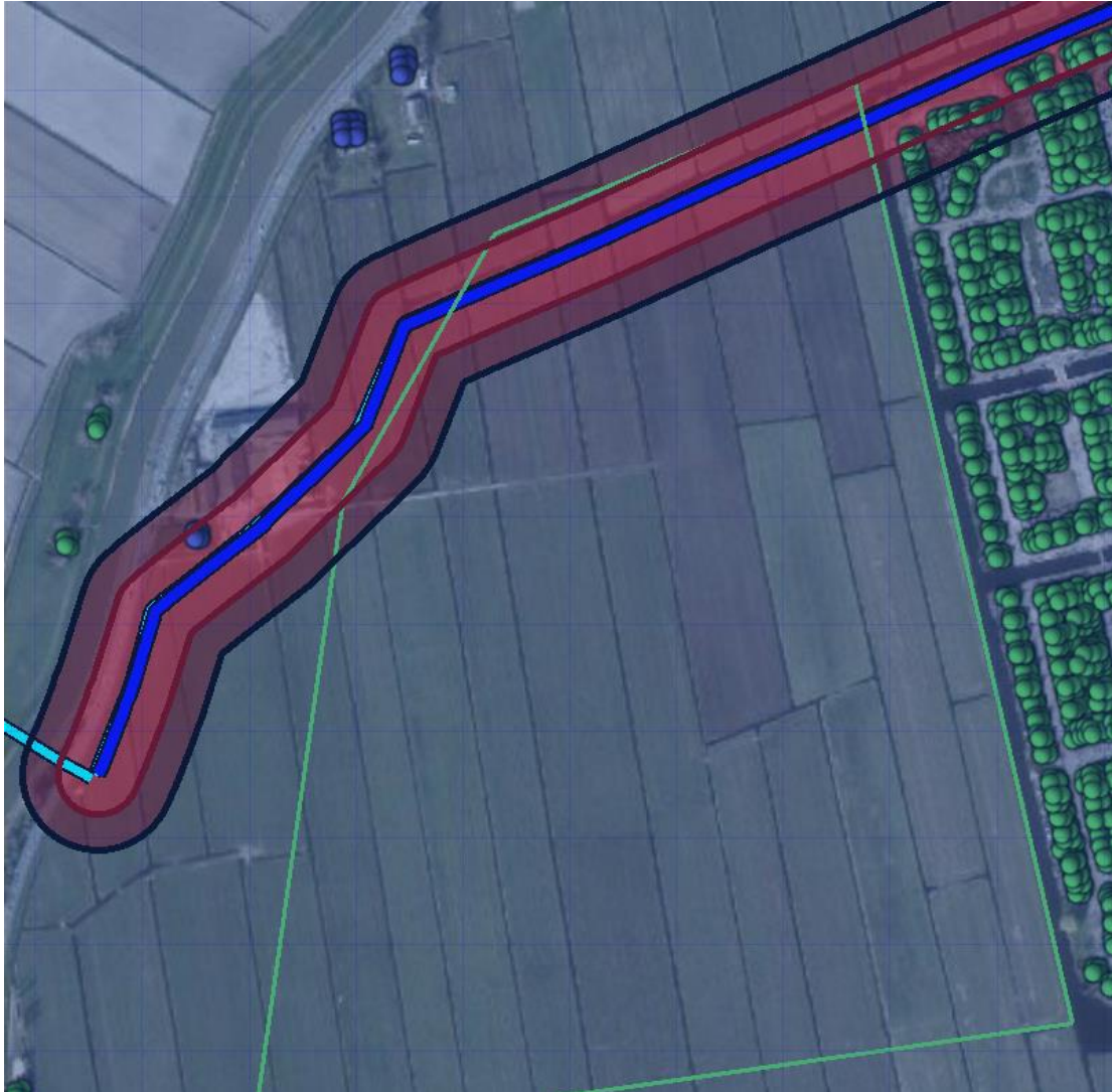
Figuur 5.2 Invloedsgebied van buisleiding W-570-21 (blauw = buisleiding, licht rood = 100 % letaliteitsgrens, donker rood = 1 % letaliteitsgrens)
